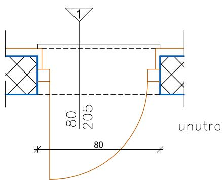
Izrada i postava protupožarnih jednokrilnih čeličnih vanjskih vrata prostora hidrostanice otpornosti na požar 60 min (EI2 60-C) dim 80x205 cm.
