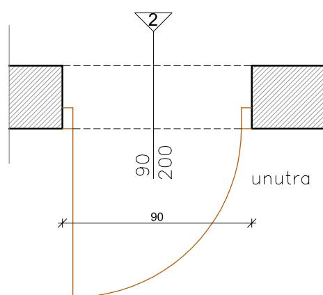
Izrada i postava protupožarnih jednokrilnih unutarnjih drvenih vrata prostora spremišta otpornosti na požar 60 min ( EI2 60-C) dim 90x200 cm.
